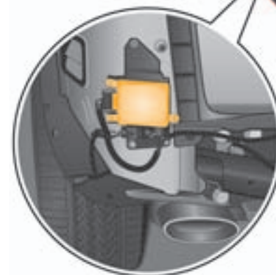
Steuergerät für Spurwechselassistent J769 hinter dem Stoßfänger, links
